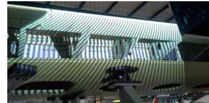
Vermessung der vorderen Sektion einer Flugzeugtragfläche mit Streifenprojektion. Länge des beleuchteten Bereichs etwa 1 m.
