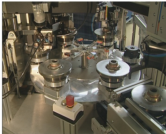
Bild 3: Torsionsschwingungsdämpfer-Schweißung auf dem Rundtakter
