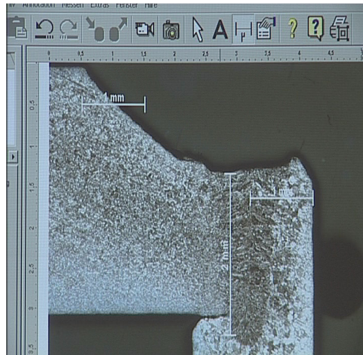
Bild 3: Schliff der Schweißnaht bei Schweißung in Blechrandlage
