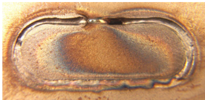
Bild 6: Nahtefall aufgrund eines zu großen Spaltes
