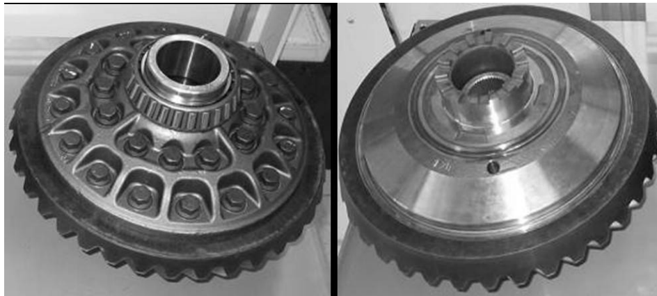
Bild 6: LKW-Achsausgleichsgetriebe: geschraubte und geschweißte Version (©Arvin Meritor)
