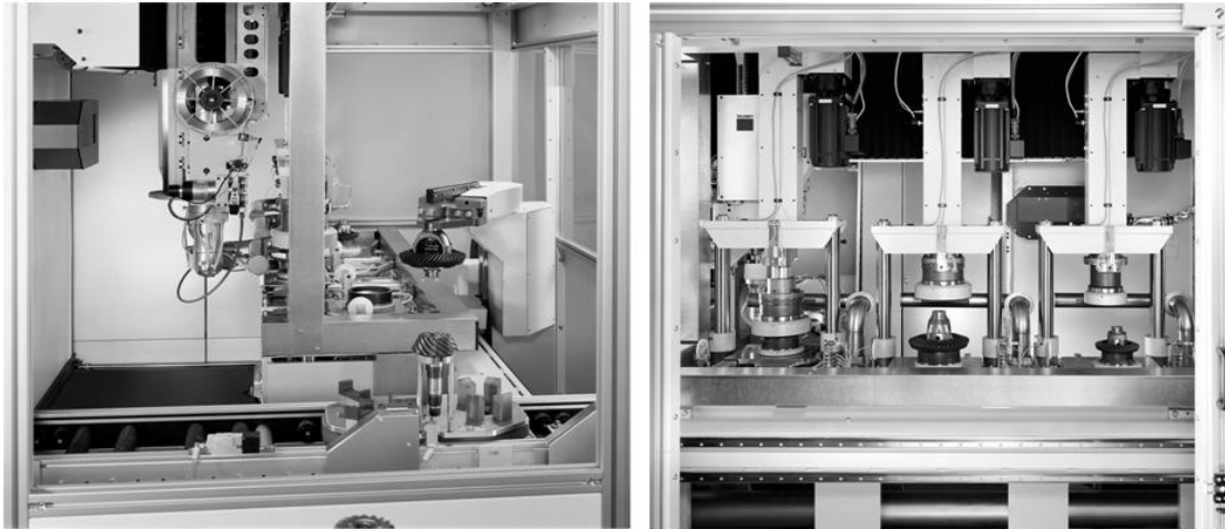
Bild 5: Laserschweißzelle für PKW-Achsausgleichsgetriebe, angebunden an eine Transportsystem mit kompaktem Ladesystem und drei Arbeitstationen zum Verpressen und Schweißen
