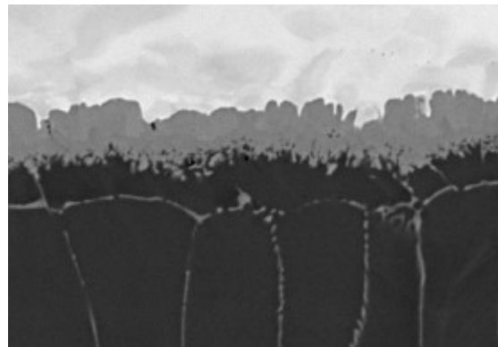
Bild 5 Rückstreuelektronenbild einer Aluminium-Stahl-Verbindung im Detail.
